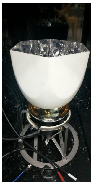
图 1 六边形光电倍增管集光器
