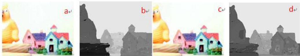
图3 深度估计结果图。(a) 原始光谱光场中心视角图, (b) 图 a 对应的深度图, (c) 重建的光谱光场中心视角图, (d) 图 c 对应的中心视角图
